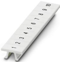
Zackband, Streifen, weiß, beschriftet, längs bedruckt: fortlaufende Zahlen 1 ... 10, 11 ... 20 usw. bis 491 ... 500, Montageart: verrasten, für Klemmenbreite: 5,2 mm, Schriftfeldgröße: 5,15 x 10,5 mm, Anzahl der Einzelschilder: 10
