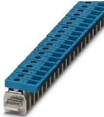
Anschlussklemme, Nennspannung: 300 V, Nennstrom: 41 A, Anschlussart: Schraubanschluss, Bemessungsquerschnitt: 4 mm<sup>2</sup>, Querschnitt: 0,5 mm<sup>2</sup> - 6 mm<sup>2</sup>, Montage: N-Sammelschiene, Farbe: blau
