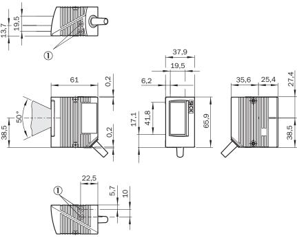
① Sacklochgewinde M5, 5 mm tief (2 x), zur Befestigung
