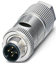
Steckverbinder, Universal, 5-polig, halogenfrei, geschirmt, Stecker gerade M12, A-kodiert, Schneidklemmanschluss, Rändelmaterial: Zinkdruckguss, vernickelt, Leitungsaußendurchmesser 5 mm ... 9,7 mm
