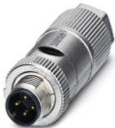
Sensor-/Aktor-Steckverbinder, 4-polig, halogenfrei, geschirmt, Stecker gerade M12 SPEEDCON, A-kodiert, Schneidklemmanschluss, Rändelmaterial: Zinkdruckguss, vernickelt, Kabelaußendurchmesser 5 mm ... 9,7 mm
