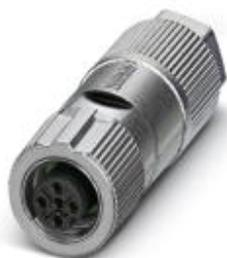
Sensor-/Aktor-Steckverbinder, 4-polig, halogenfrei, geschirmt, Buchse gerade M12 SPEEDCON, A-kodiert, Schneidklemmanschluss, Rändelmaterial: Zinkdruckguss, vernickelt, Kabelaußendurchmesser 5 mm ... 9,7 mm
