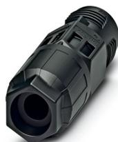
Leitungsverbinder, QUICKON-Anschluss, Polzahl: 3+PE, 1 mm<sup>2</sup> ... 2,5 mm<sup>2</sup>, 690 V, 20 A, schwarz, mit einer QUICKON-Mutter, Leitungsaußendurchmesser: 6 mm ... 10 mm, QUICKON-Schnellanschluss
