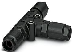
T-Verteiler, QUICKON-Anschluss, Polzahl: 3+PE, 1 mm<sup>2</sup> ... 2,5 mm<sup>2</sup>, 690 V, 20 A, schwarz, mit drei QUICKON-Muttern, Leitungsaußendurchmesser: 6 mm ... 10 mm
