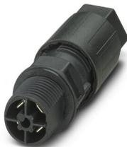
Wanddurchführung, QUICKON-Anschluss, Polzahl: 3+PE, 1 mm<sup>2</sup> ... 2,5 mm<sup>2</sup>, 690 V, 20 A, schwarz, mit QUICKON-Mutter, Leitungsaußendurchmesser: 6 mm ... 10 mm, Montagegewinde: M25, IDC-Anschluss, 2,5 mm<sup>2</sup>
