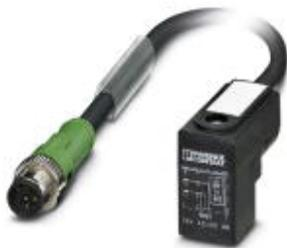
Sensor-/Aktor-Kabel, 3-polig, PUR halogenfrei, schwarzgrau RAL 7021, Stecker gerade M12 SPEEDCON, A-kodiert, auf Ventilstecker CI (9,4 mm), mit 1 LED, beschaltet mit Z-Diode, Kabellänge: 0,3 m
