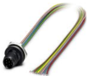
Sensor-/Aktor-Einbausteckverbinder, Stecker, 8-polig, M12, A-kodiert, Vorderwand-/Schraubmontage mit M16 Gewinde, mit 0,5 m TPE-Litze, 8 x 0,25mm 2 , Kunststoffausführung
