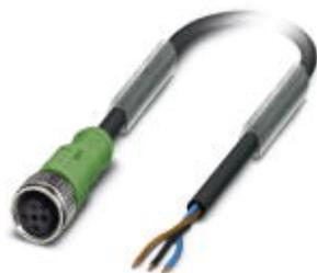
Sensor-/Aktor-Kabel, 3-polig, variabler Kabeltyp, freies Leitungsende, auf Buchse gerade M12, A-kodiert, Kabellänge: Freie Eingabe (0,2 ... 40,0 m)
