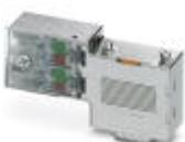
D-SUB-Stecker, 9-polig, Stift, Kabelzuführung unter 90°, Bussystem: PROFIBUS DP bis 12 MBit/s, Abschlusswiderstand über Schiebeschalter zuschaltbar, Pinbelegung: 3, 5, 6, 8; IDC-Klemmenanschluss
