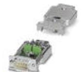
D-SUB-Stecker, 9-polig, Stift, axiale Ausführung mit zwei Kabelzuführungen, Bussystem: PROFIBUS DP bis 12 MBit/s, Abschlusswiderstand über Schiebeschalter zuschaltbar, Pinbelegung: 3, 5, 6, 8; Schraubanschlussklemmen
