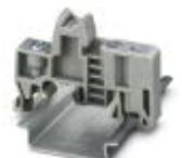
Endhalter, Breite: 9,5 mm, Höhe: 35,3 mm, Material: PA, Länge: 50,5 mm, Montage auf Tragschiene NS 32 oder NS 35, Farbe: grau
