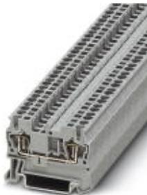
Durchgangsklemme, Nennspannung: 800 V, Nennstrom: 24 A, Anschlussart: Zugfederanschluss, Anzahl der Anschlüsse: 2, Querschnitt: 0,08 mm<sup>2</sup> - 4 mm<sup>2</sup>, AWG: 28 - 12, Breite: 5,2 mm, Farbe: grau, Montageart: NS 35/7,5, NS 35/15
