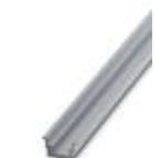
Tragschiene ungelocht, Standardprofil, Breite: 35 mm, Höhe: 15 mm, ähnlich EN 60715: 2001, Material: Aluminium, unbeschichtet, Länge: 2000 mm, Farbe: silberfarben
