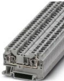
Durchgangsklemme, Nennspannung: 800 V, Nennstrom: 32 A, Anschlussart: Zugfederanschluss, Anzahl der Anschlüsse: 2, Querschnitt: 0,08 mm<sup>2</sup> - 6 mm<sup>2</sup>, AWG: 28 - 10, Breite: 6,2 mm, Farbe: grau, Montageart: NS 35/7,5, NS 35/15
