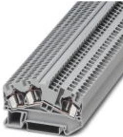
Durchgangsklemme, Nennspannung: 800 V, Nennstrom: 32 A, Anschlussart: Zugfederanschluss, Anzahl der Anschlüsse: 3, Querschnitt: 0,08 mm<sup>2</sup> - 6 mm<sup>2</sup>, AWG: 28 - 10, Breite: 6,2 mm, Farbe: grau, Montageart: NS 35/7,5, NS 35/15
