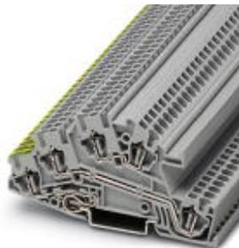
Installationsschutzleiterklemme, Zugfederanschluss, Querschnitt: 0,08 mm<sup>2</sup> - 4 mm<sup>2</sup>, AWG: 28 - 12, Breite: 5,2 mm, Farbe: grau, Montageart: NS 35/7,5, NS 35/15
