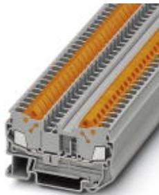
Durchgangsklemme, Nennspannung: 800 V, Nennstrom: 24 A, Anschlussart: Schnellanschluss, Anzahl der Anschlüsse: 2, Querschnitt: 0,5 mm<sup>2</sup> - 2,5 mm<sup>2</sup>, AWG: 20 - 14, Breite: 6,2 mm, Farbe: grau, Montageart: NS 35/7,5, NS 35/15
