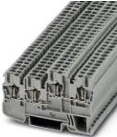
Initiatoren-/Aktorenklemme, Nennspannung: 250 V, Nennstrom: 18 A, Anschlussart: Zugfederanschluss, Anzahl der Anschlüsse: 4, Querschnitt: 0,08 mm<sup>2</sup> - 4 mm<sup>2</sup>, AWG: 28 - 12, Breite: 5,2 mm, Farbe: grau, Montageart: NS 35/7,5, NS 35/15
