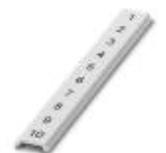
Zackband flach, Streifen, weiß, beschriftet, quer bedruckt: fortlaufende Zahlen 1-10, 11-20 usw. bis 91-100, Montageart: verrasten in flacher Schildchennut, für Klemmenbreite: 5 mm, Schriftfeldgröße: 5,15 x 5,15 mm
