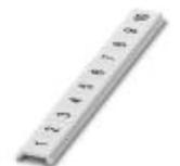
Zackband flach, Streifen, weiß, beschriftet, längs bedruckt: fortlaufende Zahlen 1-10, 11-20 usw. bis 491-500, Montageart: verrasten in flacher Schildchennut, für Klemmenbreite: 5 mm, Schriftfeldgröße: 5,15 x 5,15 mm
