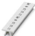
Marker für Klemmen, Streifen, weiß, beschriftet, längs: L1, L2, L3, N, PE, L1, L2, L3, N, PE, Montageart: verrasten in hoher Schildchennut, für Klemmenbreite: 5,2 mm, Schriftfeldgröße: 5,15 x 10,5 mm
