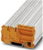
Einspeiseklemme, Nennspannung: 250 V, Nennstrom: 30 A, Anschlussart: Zugfederanschluss, Anzahl der Anschlüsse: 4, Querschnitt: 0,08 mm<sup>2</sup> - 4 mm<sup>2</sup>, AWG: 28 - 12, Breite: 10,4 mm, Farbe: orange, Montageart: NS 35/7,5, NS 35/15
