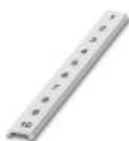
Zackband flach, Streifen, weiß, beschriftet, quer bedruckt: fortlaufende Zahlen 1-10, 11-20 usw. bis 91-100, Montageart: verrasten in flacher Schildchennut, für Klemmenbreite: 6,2 mm, Schriftfeldgröße: 5,15 x 6,15 mm
