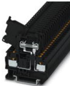
Sicherungsreihenklemme, Art der Sicherung: Glas / Keramik / ..., Anschlussart: Push-in-Anschluss, Querschnitt: 0,2 mm<sup>2</sup>- 6 mm<sup>2</sup>, AWG: 24 - 10, Nennstrom: 6,3 A, Nennspannung: 500 V, Breite: 6,2 mm, Sicherungstyp: G / 5 x 20, Montageart: NS 35/7,5, NS 35/15, Farbe: schwarz
