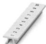
Zackband, Streifen, weiß, beschriftet, längs bedruckt: fortlaufende Zahlen 1-10, 11-20 usw. bis 491-500, Montageart: verrasten in hoher Schildchennut, für Klemmenbreite: 5,2 mm, Schriftfeldgröße: 5,15 x 10,5 mm
