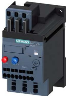
Überlastrelais 11...16 A thermisch für Motorschutz Baugröße S00, CLASS 10 Einzelaufstellung Hauptstromkreis: Federzugklemme Hilfsstromkreis: Federzugklemme Hand-Automatik-RESET
