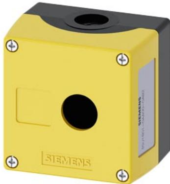
Gehäuse für Befehlsgeräte, 22 mm, rund, Gehäusematerial Kunststoff, Gehäuseoberseite gelb, 1 Befehlsstelle Kunststoff, Vertiefung für Schild, ohne Bestückung
