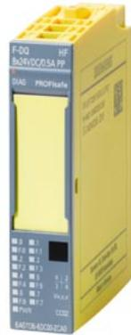
SIPLUS ET 200SP F-DQ 8x24VDC/0.5A PP HF based on 6ES7136-6DC00-0CA0 mit Conformal Coating, -30...+60°C, fehlersichere Digitalausgänge Cat.4, PL e (EN ISO 13849-1) bis SIL 3 (IEC 61508)
