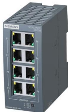
SCALANCE XB008 unmanaged Industrial Ethernet Switch für 10/100 Mbit/s; zum Aufbau von kleinen Stern- und Linienstrukturen; LED-Diagnose, IP20, AC/DC 24V Spannungsversorgung, mit 8x 10/100 Mbit/s Twisted Pair Ports mit RJ45-Buchsen; Handbuch als Download verfügbar .
