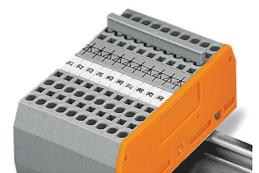
Schutzleiterklemmen lassen sich mit Querbrückern in einer Richtung (über die Klemmenrückwand) mit Durchgangsklemmen brücken. Zusätzlich zur Kennzeichnung dieser Klemmen empfehlen wir die Verwendung der gelbgrünen Querbrücker.
