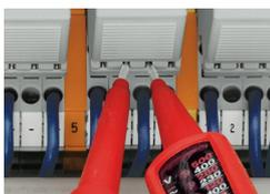
Funktionsprüfung an berührungsgeschützten Tipprückkontakten
