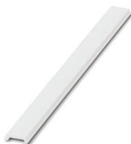
Zackband flach, Streifen, weiß, unbeschriftet, beschriftbar mit: PLOTMARK, CMS-P1-PLOTTER, Montageart: verrasten, für Klemmenbreite: 16 mm, Schriftfeldgröße: 16,25 x 10,5 mm, Anzahl der Einzelschilder: 50
